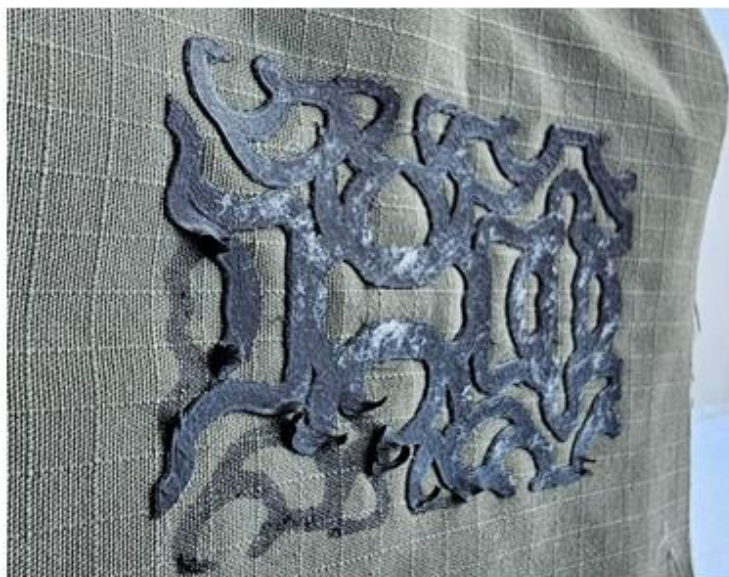
Рисунок 2.13 – Дефект «Изменение целостности орнамента объемного элемента из термопластика». Время адгезии – 25 сек., толщина 3D-элемента – 0,5 мм
