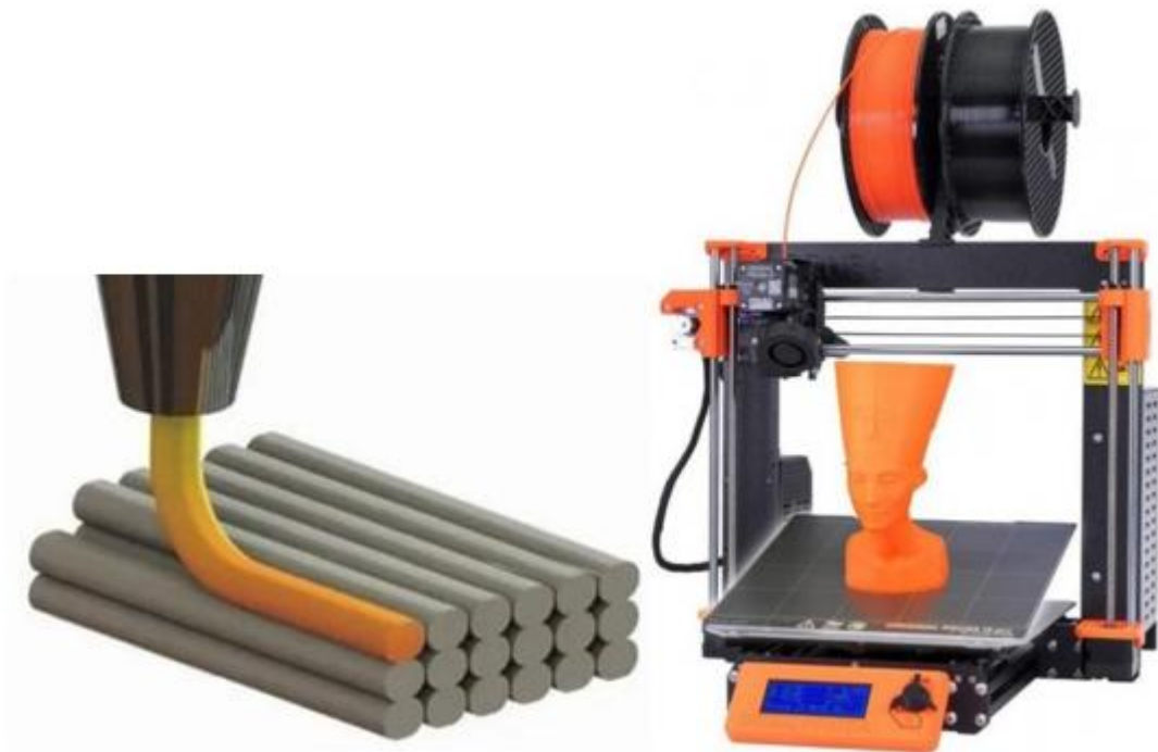
Рисунок 1.2 – Технология объемной печати FDM [47], 3D-принтер Original Prusa i3 MK3S+ [48]
