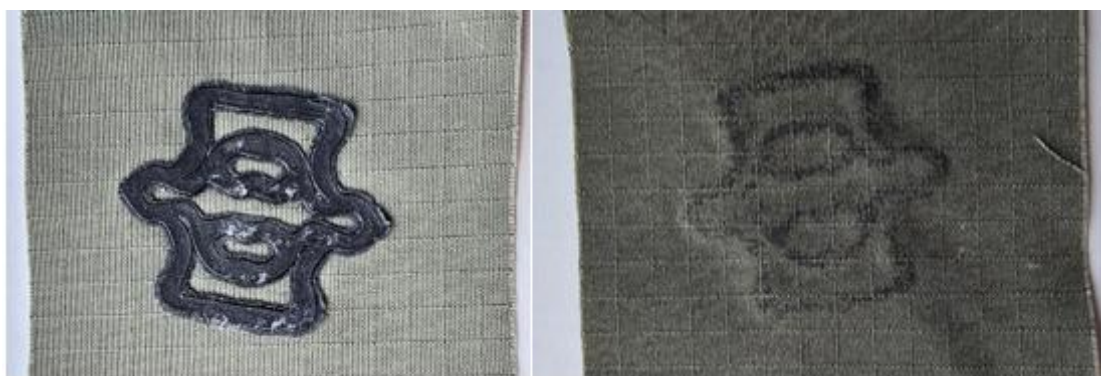
Рисунок 2.12 – Дефект «Проникновение полимера на изнаночную сторону текстильного материала». Время адгезии – 45 сек., толщина 3D-элемента 1,25 мм, где: а – лицевая сторона ткани, б – изнаночная сторона ткани
