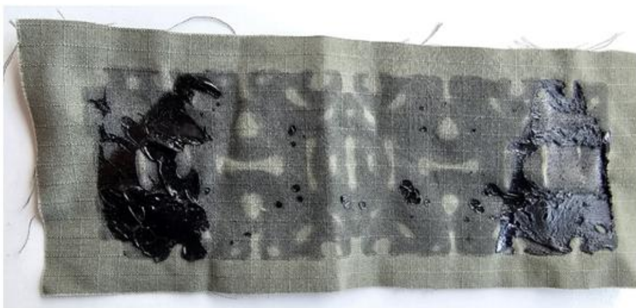
Рисунок 2.11 – Дефект «Переход объемного элемента из термопластика в вязкотекучее состояние». Время адгезии – 50 сек., толщина 3D-элемента 2,25 мм
