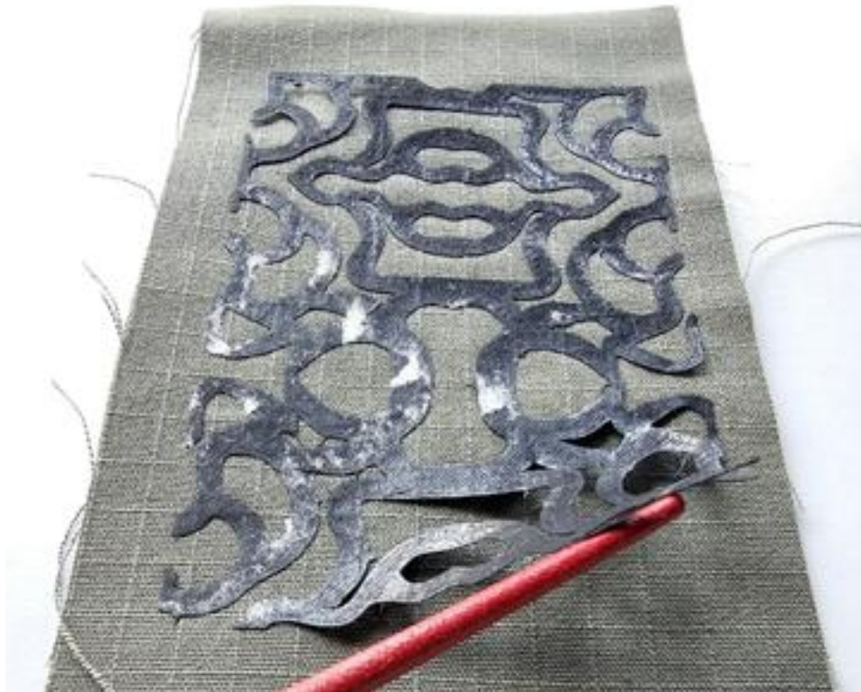
Рисунок 2.14 – Дефект «Расслаивание». Время адгезии 10 сек., толщина 3D-элемента – 0,25 мм
