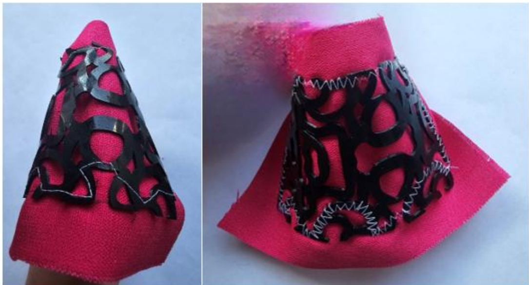
Рисунок 2.5 – Пустоты у образцов настрачивания объемных элементов из полимера на текстильный материал, где: а – двухниточный одноигольный прямой челночный стежок, б – двухниточный одноигольный зигзагообразный челночный стежок
