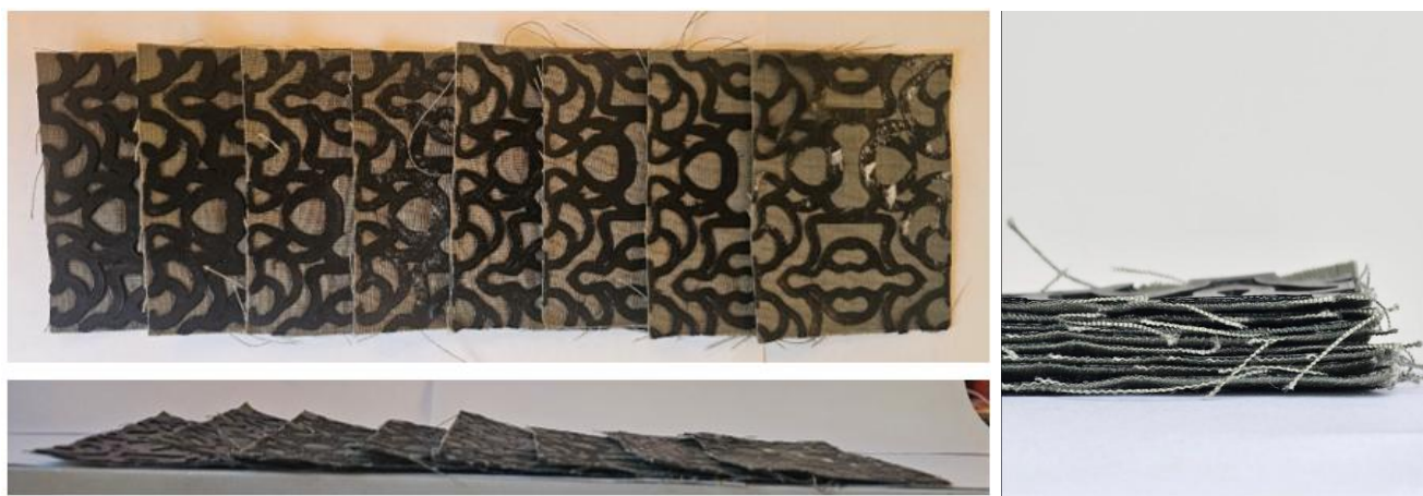
Рисунок 2.7 – Внешний вид экспериментальных образцов с полимерными элементами толщиной от 0,25 мм до 0,75 мм
