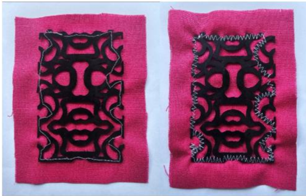
Рисунок 2.4 – Внешний вид образцов, в которых для соединения полимерного элемента с текстильным материалом использованы, где: а – двухниточный одноигольный прямой челночный стежок, б – двухниточный одноигольный зигзагообразный челночный стежок
